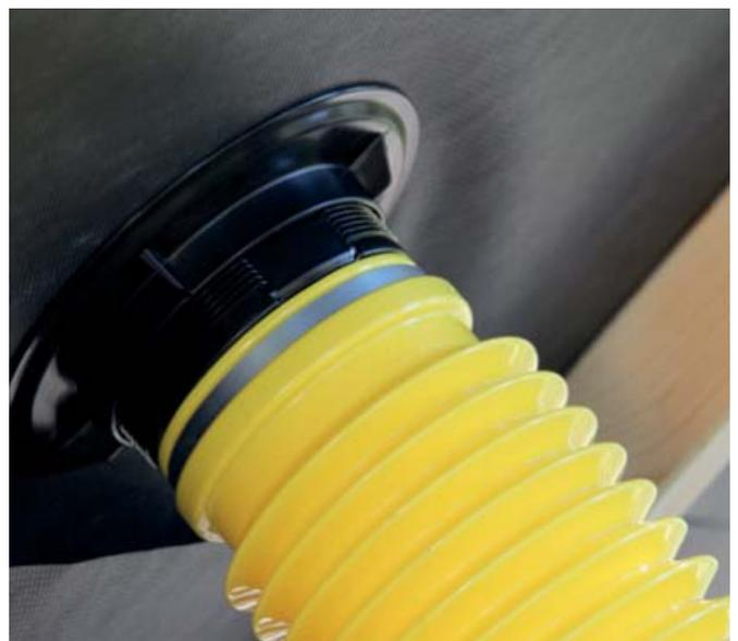
Der ERGO-Dachbahnanschluss ist die sichere Lösung für den optimalen Anschluss an das Unterdach gegen Wassereintritt und Luftverlust. Durch die zweiteilige Ausführung ist das Element universell einsetzbar auf jede Schalungsdicke (bis max. 32 mm) oder direkt auf die Dachbahn (ohne darunterliegende Holzschalung). Die Abdeckungsflächen decken den Holzausschnitt sauber ab.
